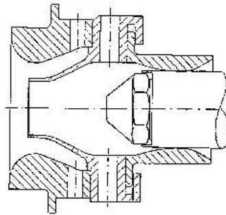
Fig. 3 Air blast atomiser
