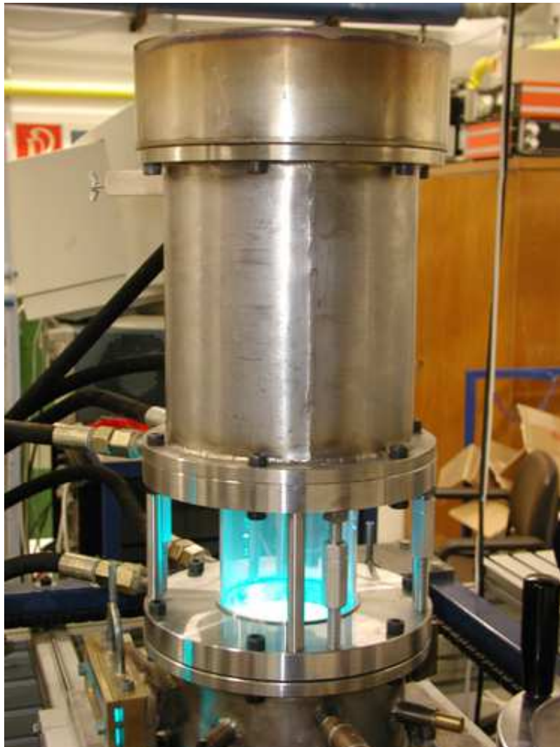
Versuchsstand zur Untersuchung hochturbulenter Flammen
